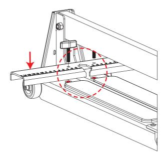
Аналогично боковая линейка и боковая направляющая в разобранном виде крепятся к отверстиям на боковой стороне корпуса.
